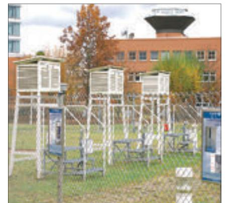
Für Messungen am Boden waren die Sensoren früher in solchen weißen Wetterhütten untergebracht. Sie wurden zum Symbol für die Meteorologie.
